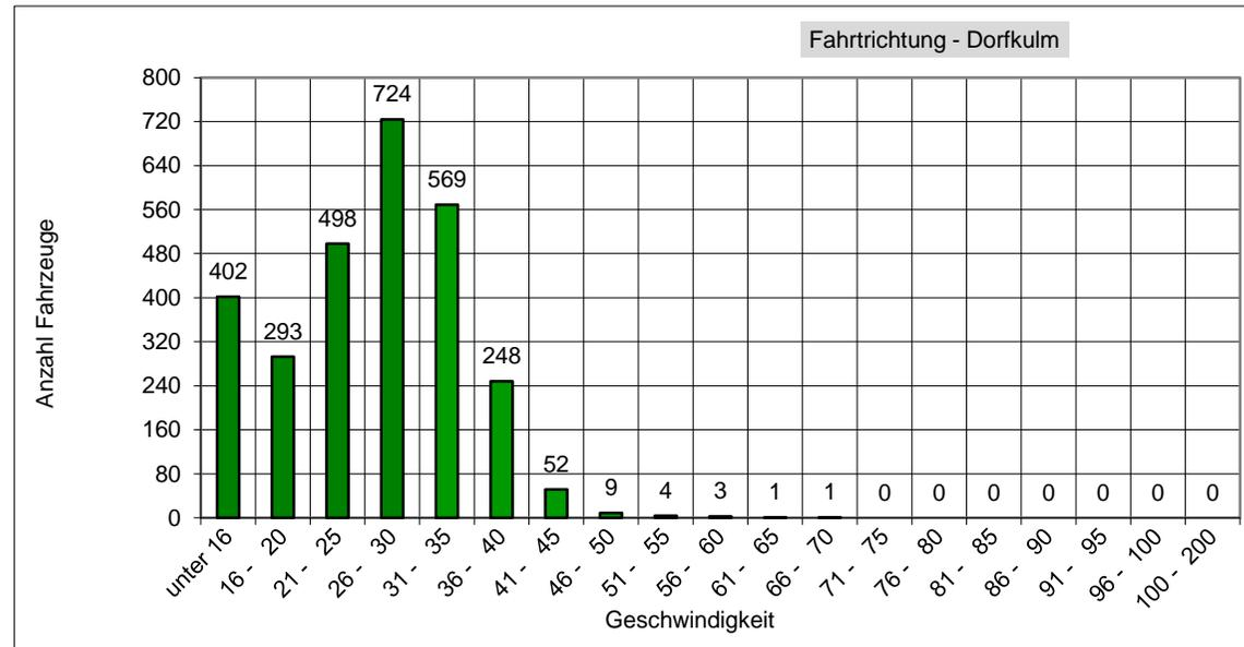
**v85:** Dieser Wert wird in km/h ausgegeben und bedeutet, dass 85% der gemessenen Fahrzeuge diese Geschwindigkeit nicht überschritten haben. Dieser Wert ist maßgeblich für ggf. weitere verkehrsrechtliche Maßnahmen. Je näher der Wert der v85 an der zulässigen Höchst- geschwindigkeit am Messort liegt,
