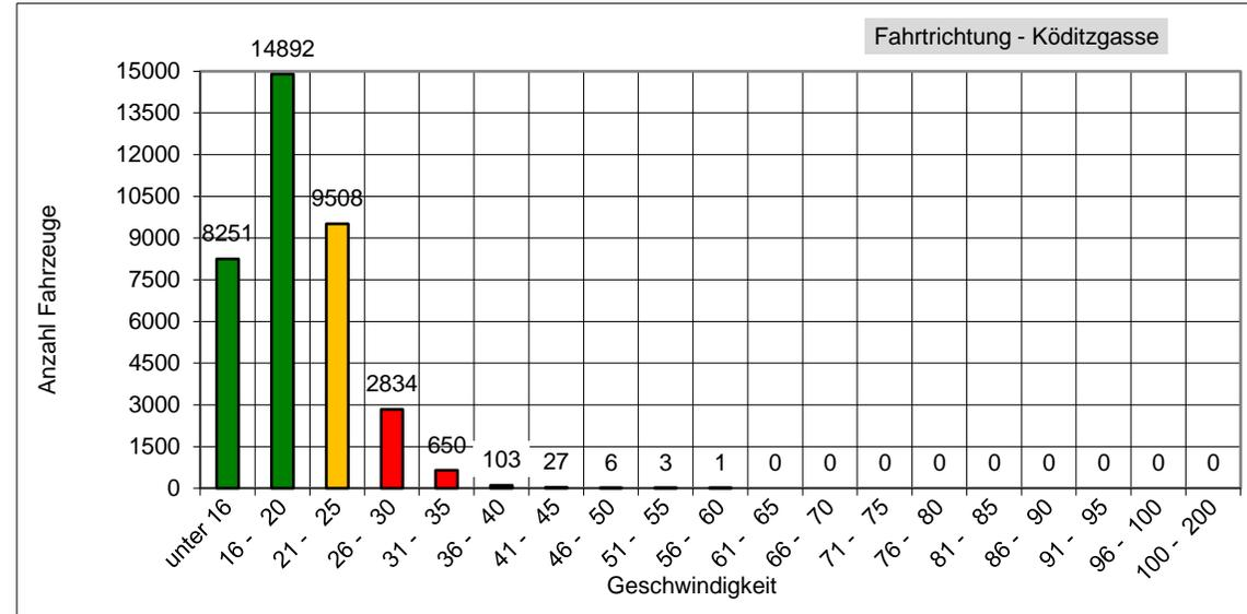
**v85:** Dieser Wert wird in km/h ausgegeben und bedeutet, dass 85% der gemessenen Fahrzeuge diese Geschwindigkeit nicht überschritten haben. Dieser Wert ist maßgeblich für ggf. weitere verkehrsrechtliche Maßnahmen. Je näher der Wert der v85 an der zulässigen Höchst- geschwindigkeit am Messort liegt,
