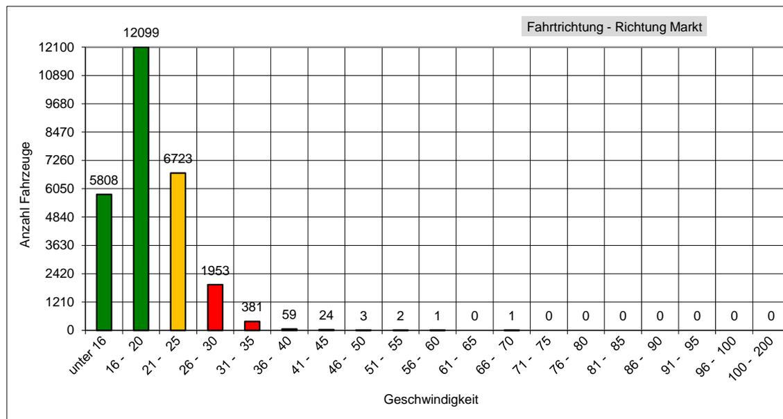
**v85:** Dieser Wert wird in km/h ausgegeben und bedeutet, dass 85% der gemessenen Fahrzeuge diese Geschwindigkeit nicht überschritten haben. Dieser Wert ist maßgeblich für ggf. weitere verkehrsrechtliche Maßnahmen. Je näher der Wert der v85 an der zulässigen Höchst- geschwindigkeit am Messort liegt, desto besser.
