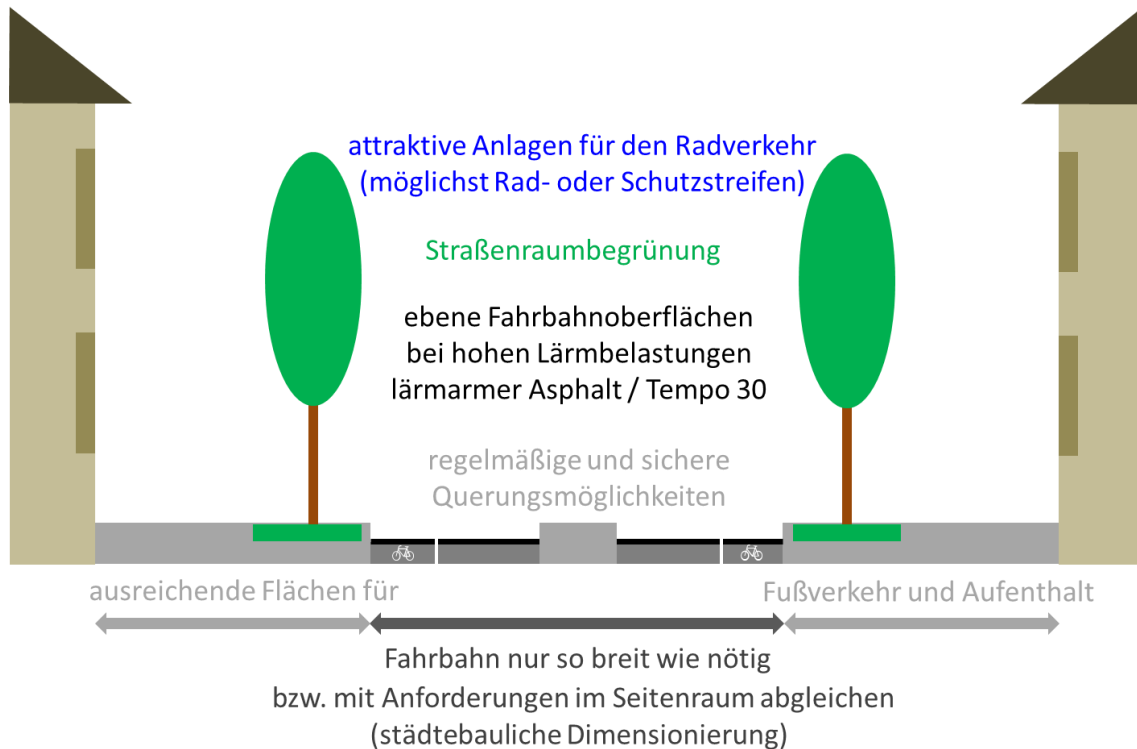
Abb. 27 idealtypischer Straßenquerschnitt im Sinne der Lärminderung
